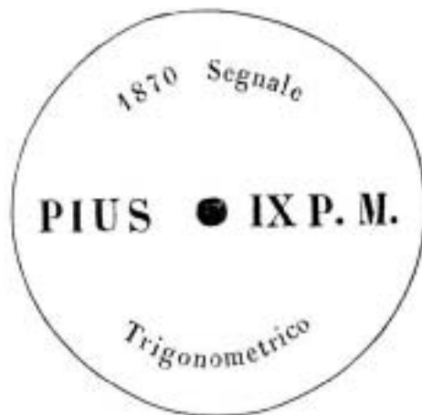
Fig. 2 – La pietra-testimone del punto trigonometrico fondamentale (cfr. A. SECCHI, Rapporto della Commissione per la misura del meridiano centrale europeo negli Stati Pontifici presentato a sua Eminenza Reverendissima il sig. Cardinale Giuseppe Berardi nel giorno 1 agosto 1870, Roma (1871) (Roma, Biblioteca Casanatense, Misc. 698.19).
