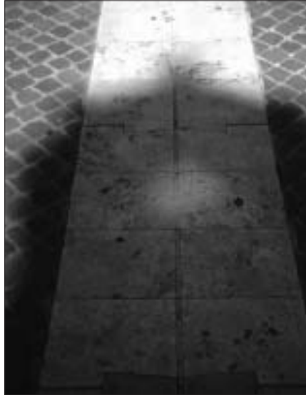
Fig. 7 – L'immagine stenopeica del Sole al transito al meridiano il 5 agosto 2006. L'estremo superiore dell'ombra indica il giorno. Tra una tacca di bronzo e l'altra ci sono circa 7 giorni e mezzo. Qui l'ombra cade circa 17 giorni dopo il 21 luglio (ingresso del Sole nel Leone).
