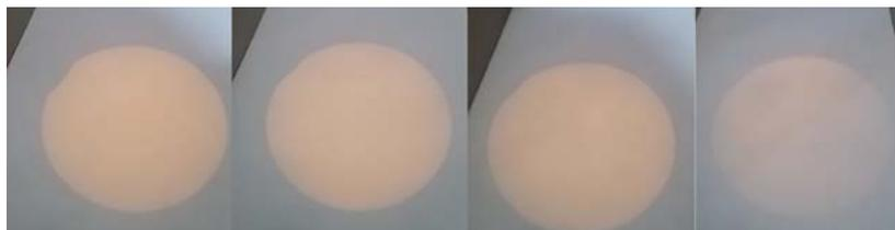
Fig. 7 Le immagini di cui sono state misurate le corde in rapporto alla lunghezza del diametro, per estrapolare l'istante di ultimo contatto tra Sole e Luna. Si tratta di immagini proiettate dalla lente equinoziale (fatta nel 2000) della cupola d'ingresso di Santa Maria degli Angeli, poco fuori fuoco; le macchie solari apparivano oblunghe: è l'astigmatismo di Petzval intra o extra focale.
