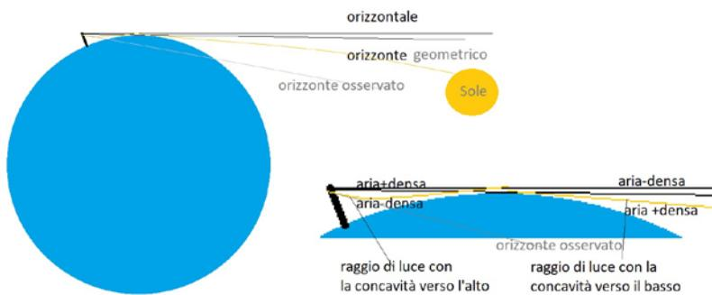
Fig.4 Schema del percorso dei raggi dietro e davanti l'orizzonte.
