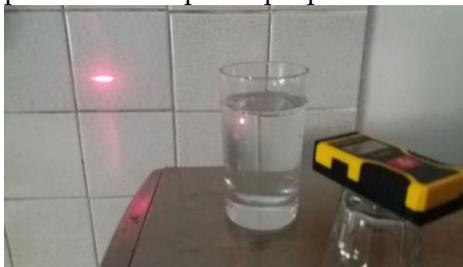
Fig. 1 la luce LASER è focalizzata su una linea orizzontale a causa dell'aberrazione sferica subita sullo stesso piano, mentre si allunga su e giù parallela all'asse del cilindro, per l'astigmatismo.
