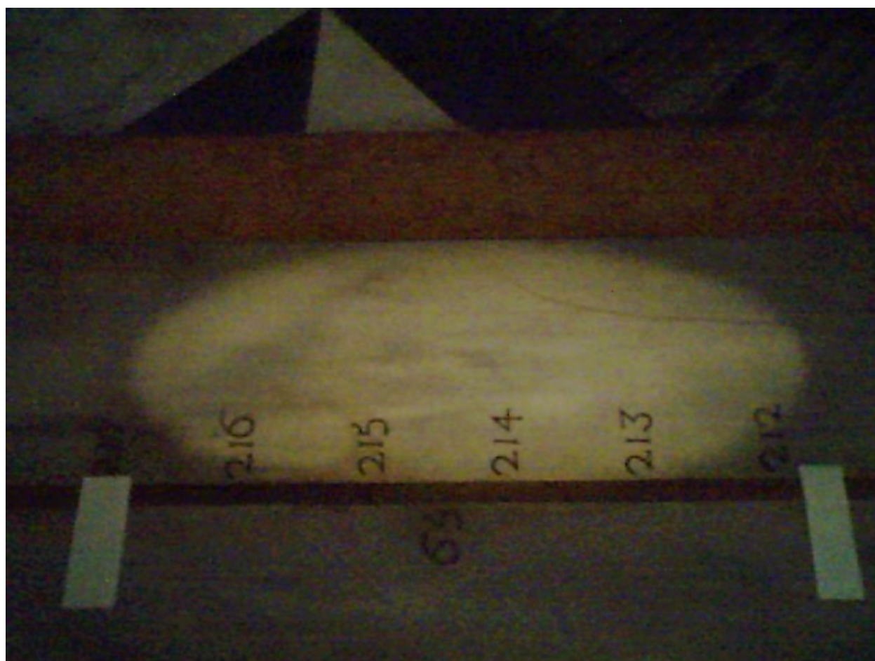
Foto del 31 Dicembre 2007 in S. Maria degli Angeli con fasce millimetriche per misurare i bordi dell'immagine solare
