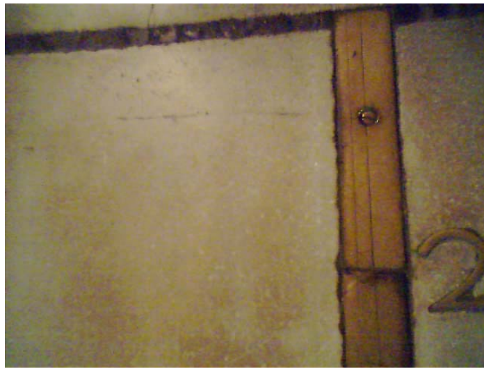
Fig. 4 Dettaglio della fine della Linea presso la 220esima parte centesima. Si nota la giunzione tra le due liste di ottone, dove spesso abbiamo misurato discontinuità rispetto al filo teso. La Linea Clementina è quella al centro della lista di ottone. L'Ovest è a sinistra; il filo a 220 passava quasi 4 decimi di mm a destra della Linea Clementina, e al termine, in alto, coincideva con l'origine della Linea.
