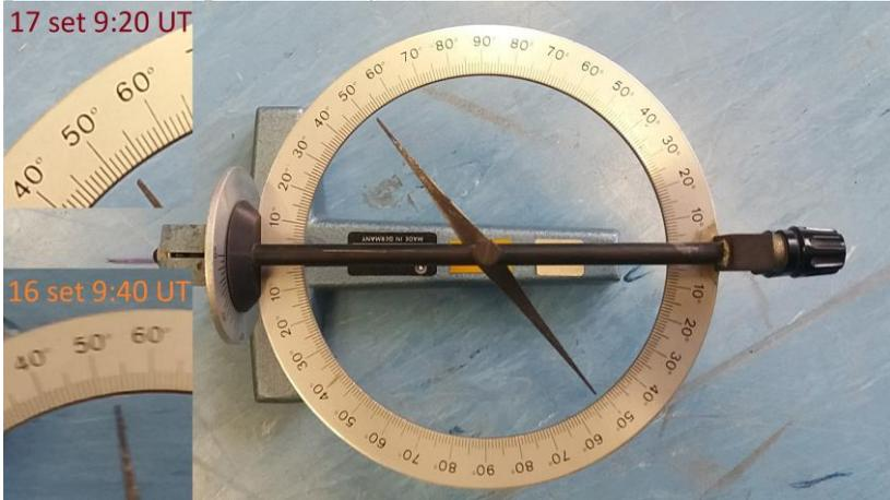
Fig. 1 Bussola delle inclinazioni, durante la tempesta geomagnetica del 17 settembre 2021 non rileva variazioni  $>0.5^\circ$
