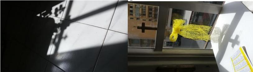
Fig. 7 Ombra di una croce a 2.08 m e a 0.4 m: notare i contorni.
