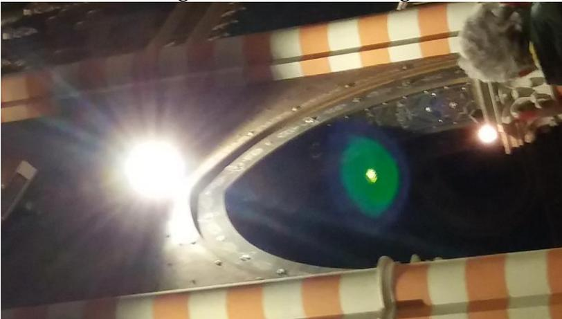
Fig. 1 Questa foto è scattata in automatico a ISO 200 f=4mm a f/1.9 e 1/17 s di tempo di posa, in condizioni simili all'occhio umano; si vede la ghost image in cui appare la matrice di LED.
