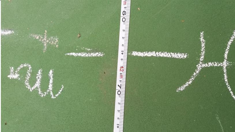
Fig. 2 La posizione dei Pesci-Scorpio (misurata il 18 febbraio 2021 h 12:24) a 12.65 m dal muro fissa l'altezza dello gnomone a 976.6 cm.
